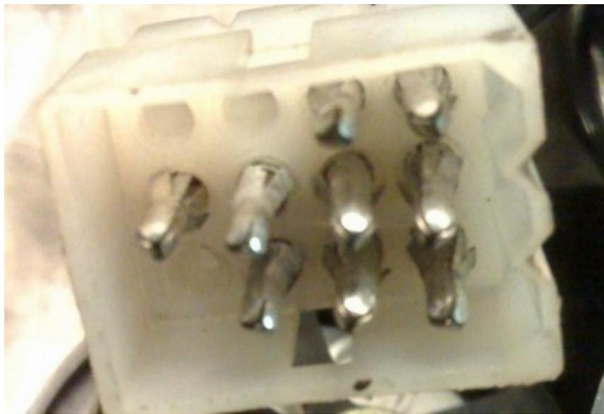
... utilizzando una pinzetta è possibile avvicinare i fermi e, tirando il filo, estrarre i piedini UNO ALLA VOLTA per poi saldare il filo al piedino e reinfilarlo nel rispettivo alloggiamento.
